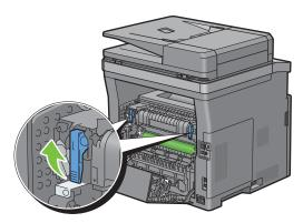
Si le document est coincé en dessous du module de fusion, retirez le document coincé du dessous du module de fusion.
