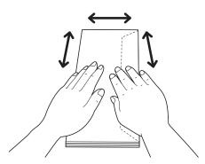
REMARQUE: La hauteur (quantité) maximale de la pile d'enveloppes dans le chargeur multifonction est d'environ 15 mm (0,59 pouse) (15 enveloppes).
