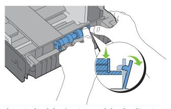
4 Chargez du papier dans le bac 1, puis insérez le bac dans l'imprimante et poussez-le jusqu'au bout.
