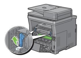
Faites glisser les sélecteurs d'enveloppe des deux côtés du module de fusion vers la position [].
