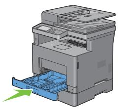
11 Insérez le MPF dans l'imprimante, poussez-le jusqu'au bout, puis fermez le capot du MPF.
