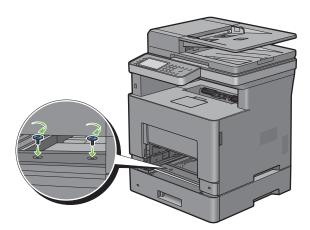
10 Insérez le bac l'dans l'imprimante et poussez-le jusqu'au bout.
