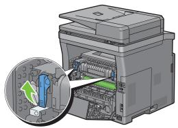
3 Faites glisser les sélecteurs d'enveloppe des deux côtés du module de fusion vers la position 📳 .
