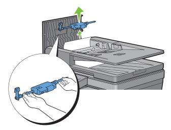
Réinsérez les rouleaux d'entraînement et abaissez le levier d'extraction.
