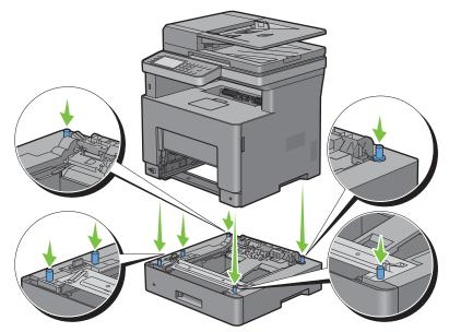
9 À l'aide d'une pièce de monnaie ou d'un objet similaire, fixez le chargeur 550 feuilles en option sur l'imprimante en serrant les deux vis prévues avec le chargeur.
