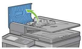
2 Essuyez le rouleau d'entraînement du CADRV avec un chiffon doux non pelucheux ou du papier absorbant jusqu'à ce qu'il soit propre.
