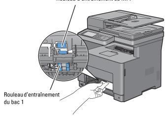
7 Insérez le bac1 dans l'imprimante et poussez-le jusqu'au bout.
