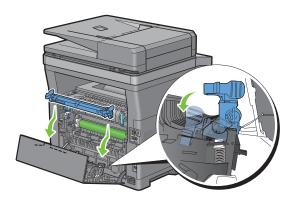
4 Alignez les flèches de l'unité de transfert avec celles de l'imprimante, puis pressez les deux languettes de l'unité de transfert vers l'intérieur pour les verrouiller.
